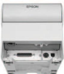
Es fácil cambiar entre interfaces de datos intercambiables y la conexión USB estándar.
