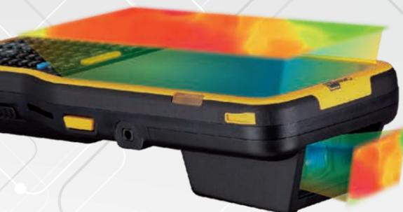
✓ Sensor de temperatura y calentador controlado por software permitiendo activar y desactivar el calentador de forma precisa y automática de acuerdo al ambiente que se encuentre. Por ejemplo, establecer activación de calentador por debajo de -10°C y desactivar por encima de 20°C.
