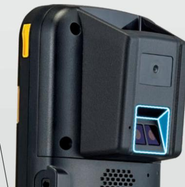
Opción de cámara 13MP diseñada con ángulo específico para tomar fotos sin inconvenientes incluso con la empuñadura puesta.
